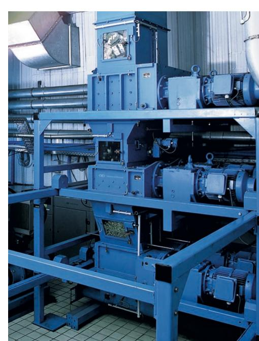
Nach dem Absaugen und dem Vermischen im Silo werden die Shreds in der Regel mit leistungsstarken Hydraulikpressen zu kompakten Briketts verdichtet.
